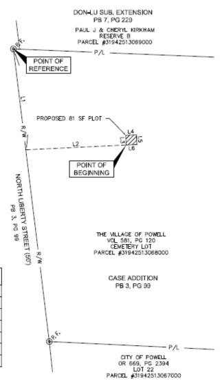
LINE TABLE UNE # DIRECTION LENGTH L1 S07"00"01"E 89.52 N87"14"14"E 88.63 L3 N02'45'46"W 8.50 N87"14"14"E 9.50 L4 S02'45'46"E 8.50 L6 S87"14"14"W 9.50
